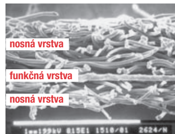
Prierez trojvrstvou fóliou (výstuha – funkčná vrstva – výstuha)
