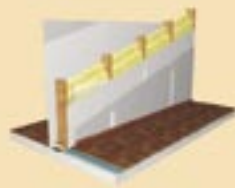
Drevená spodná konštrukcia
