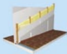
Drevená spodná konštrukcia
