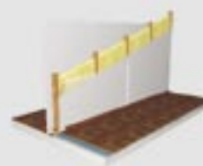
Drevená spodná konštrukcia
